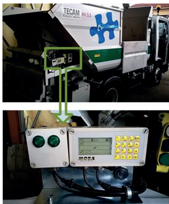
Fig. 2 – Sistema tecnologico a bordo mezzo per la lettura automatica dei sacchi Rfid
