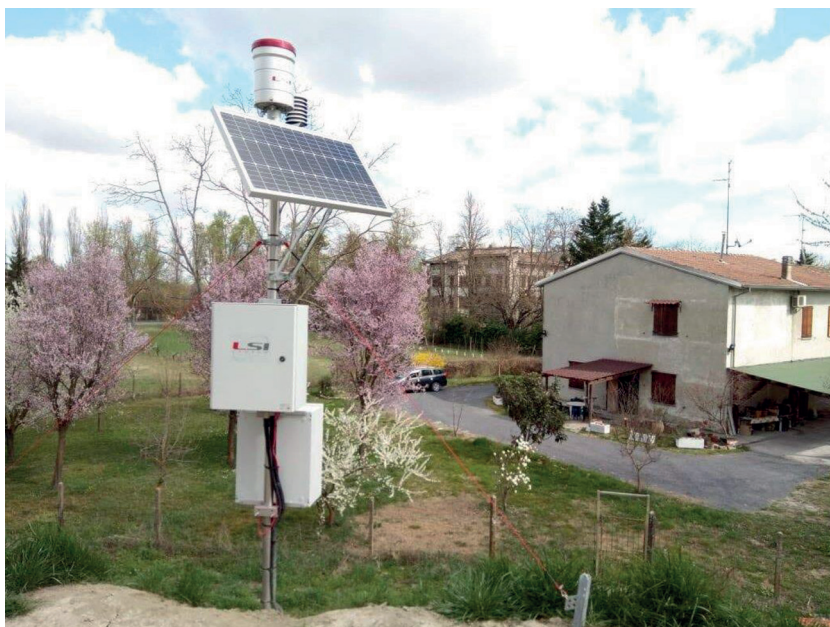
Fig. 1 – Centralina di monitoraggio geoelettrico G.Re.T.A. installata a Colorno (PR) su un argine del Torrente Parma, unitamente ad una stazione meteorologica
